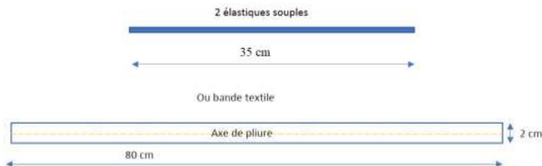
Figure 8 —à plis - Dimensionnement du jeu de brides
